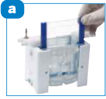
a Basınç çerçevesi ile conta arasına cam plakalar yerleştirin
