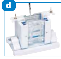
d Jel solüsyonunu yerleştirin ve tarayın ve polimerleşmeye bırakın
