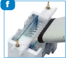
f Yükleme Kılavuzlarını kullanarak örnekleri yükleyin ve çalıştırın
