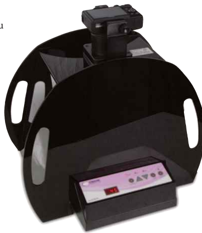
Başlık, görüntü yakalamaya uygun, ışık geçirmez bir ortam oluşturmak için runVIEW tankının ve ana ünitenin üzerine yerleştirilmiştir
