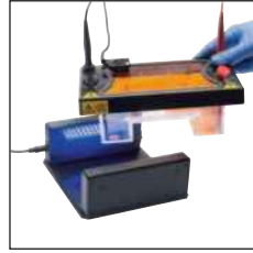
mavi ışık kaynağı, hem MINI hem de MIDI ünitelerini barındırmak için sürgülü bir panele sahiptir
